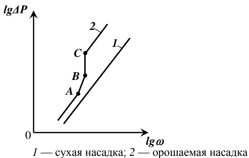
Рисунок 4 - Зависимость гидравлического сопротивления насадки от скорости газа в колонне ( L = \text{const} )
