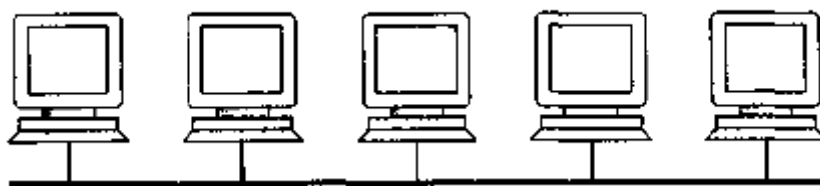
Рис. 1. Структура шинной топологии вычислительной сети
