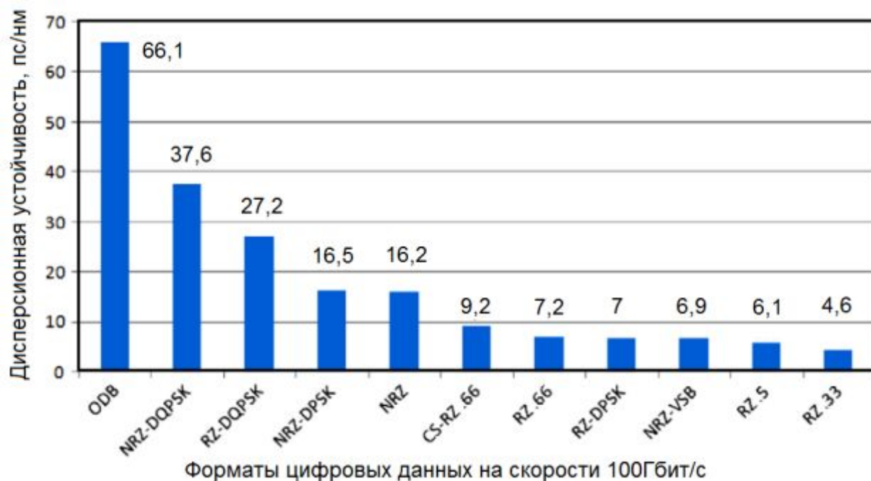
Рис. 2.1. Пример допустимых значений дисперсии для различных форматов данных для скорости 100 Гбит/с в оптическом канале [20]
