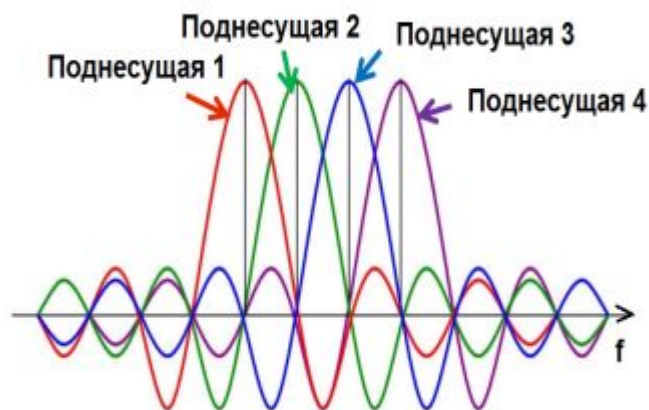
Рис. 5.9. Размещение подканалов в оптическом суперканале OFDM
