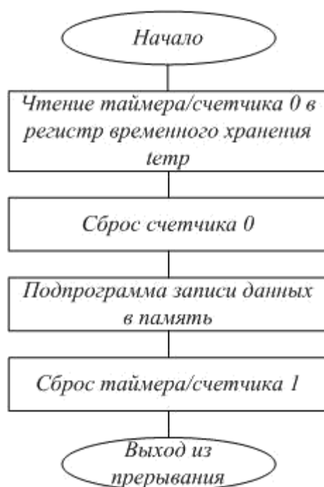
Рис. 2.4. Пример алгоритма обработки прерывания int_0c
