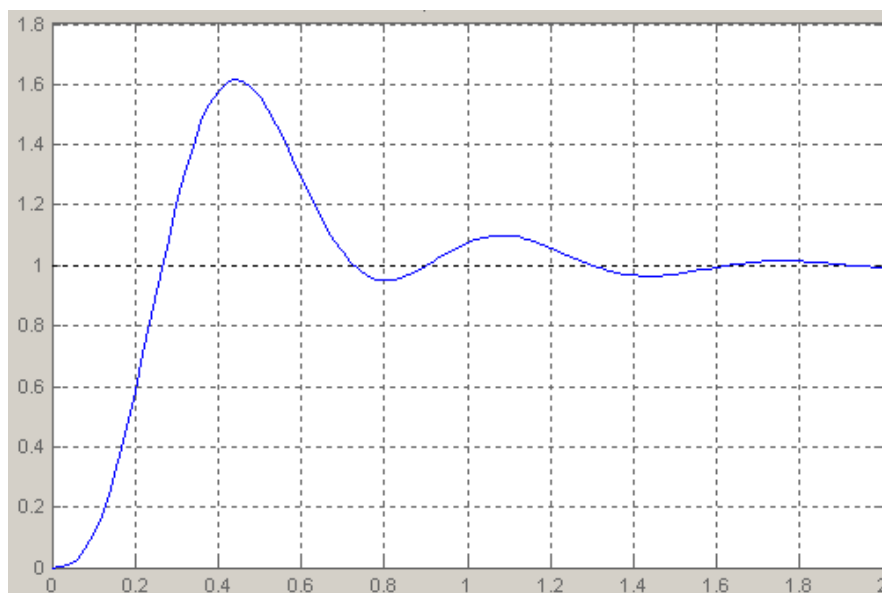
Рис. 5.2.3 Переходная характеристики с ПИ-регулятором
