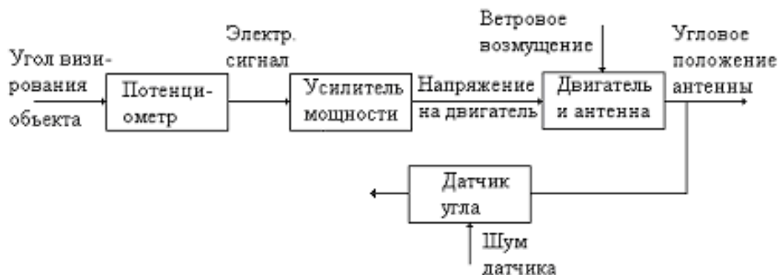
Рис. 5.8. Структура неизменяемой части системы управления антенной
