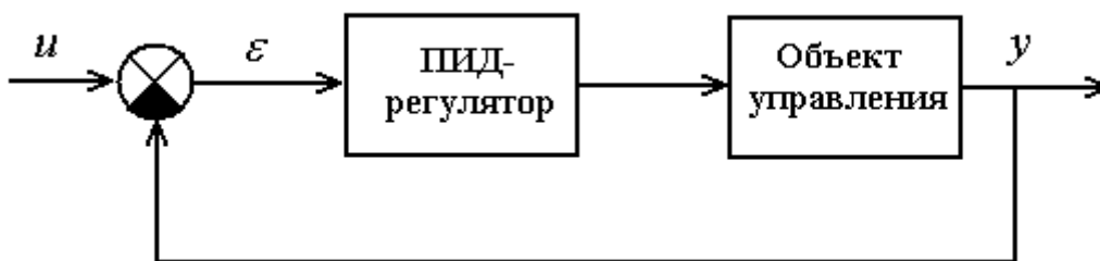
Рис. 5.19. Замкнутая система с ПИД-регулятором
